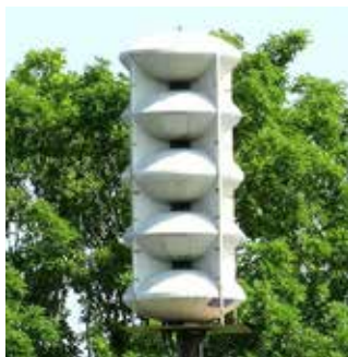
Figura 11: Sirene eletrônica omnidirecional empilhada em células
